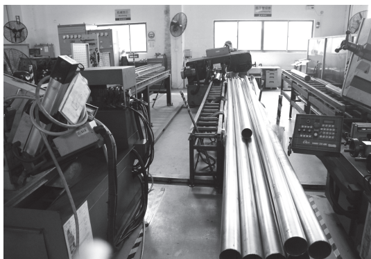
パイプの切断
