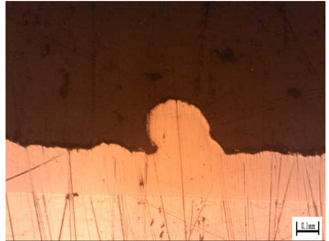
図 7 めっき断面に観察された突起状ニッケル
