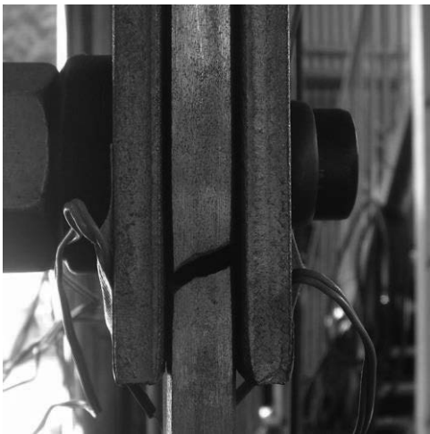
写真-4 母材破断状況 (M3)
