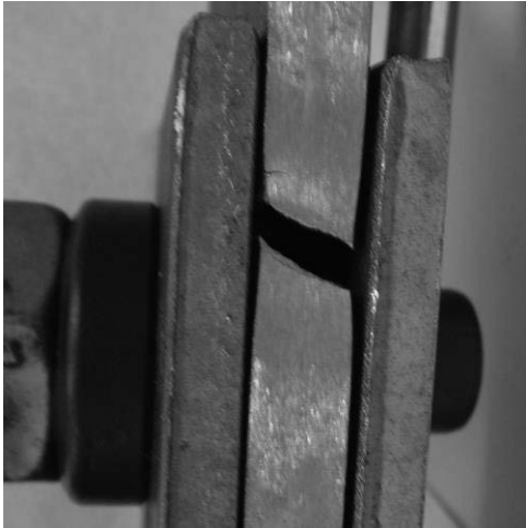
写真-3 母材破断状況 (M2)
