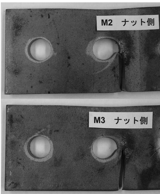
写真-5 母材破断状況 (ナット側)
