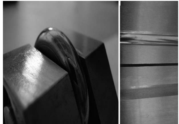
図4 バニッシング・ローラーの拡大図(左)および加工後の溝形状(右上)および加工前の溝形状(右下)
