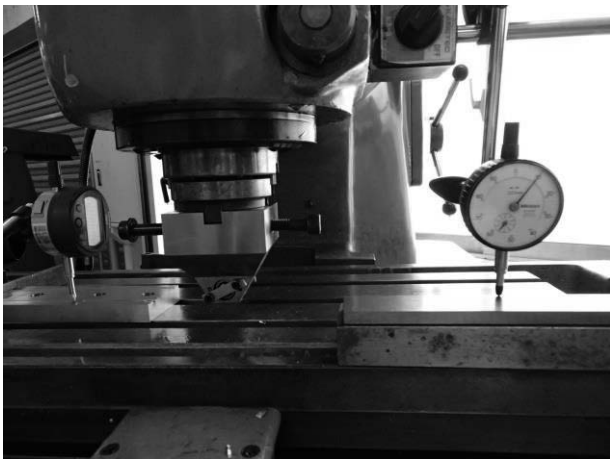
図3 フライス盤に装着されたバニッシング・ローラー
