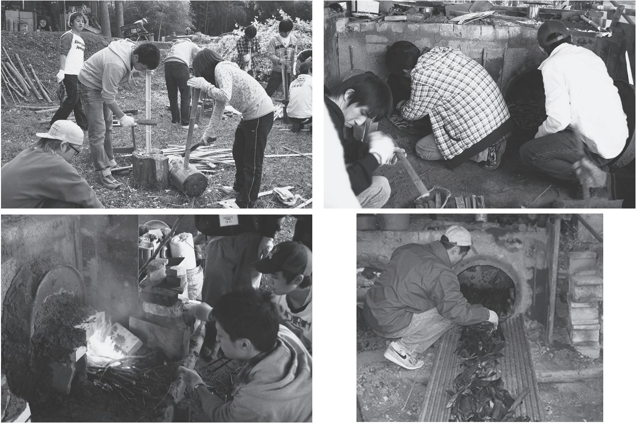
Fig. 4 竹割り、窯詰め、点火、竹炭の取り出し作業
