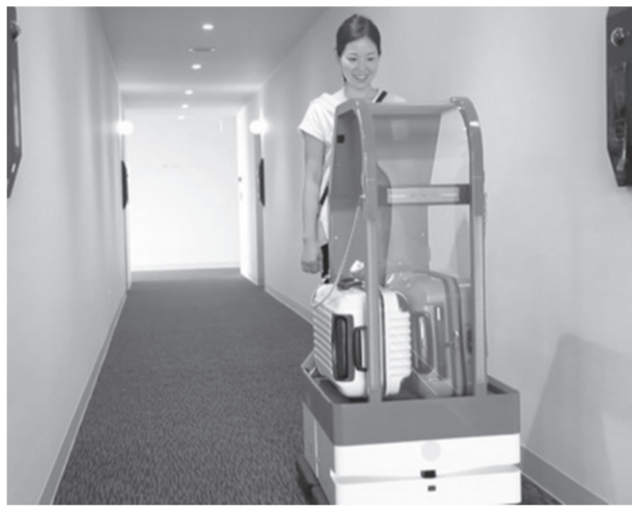
写真 10 - ポーターロボット運搬中②
