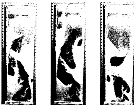
図10：充填層高 h_T = 400\text{mm} における流動状態の連続写真 (写真間隔 3 コマ/秒)
