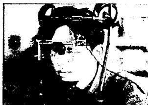
写真1 強膜反射法におけるセンサつき眼鏡 (右は眼鏡を装着し顔面固定したところ)
