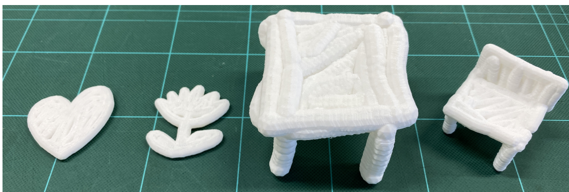
図 6.11: 3D プリンタにて出力されたモデル (ハート，花，机，椅子)
