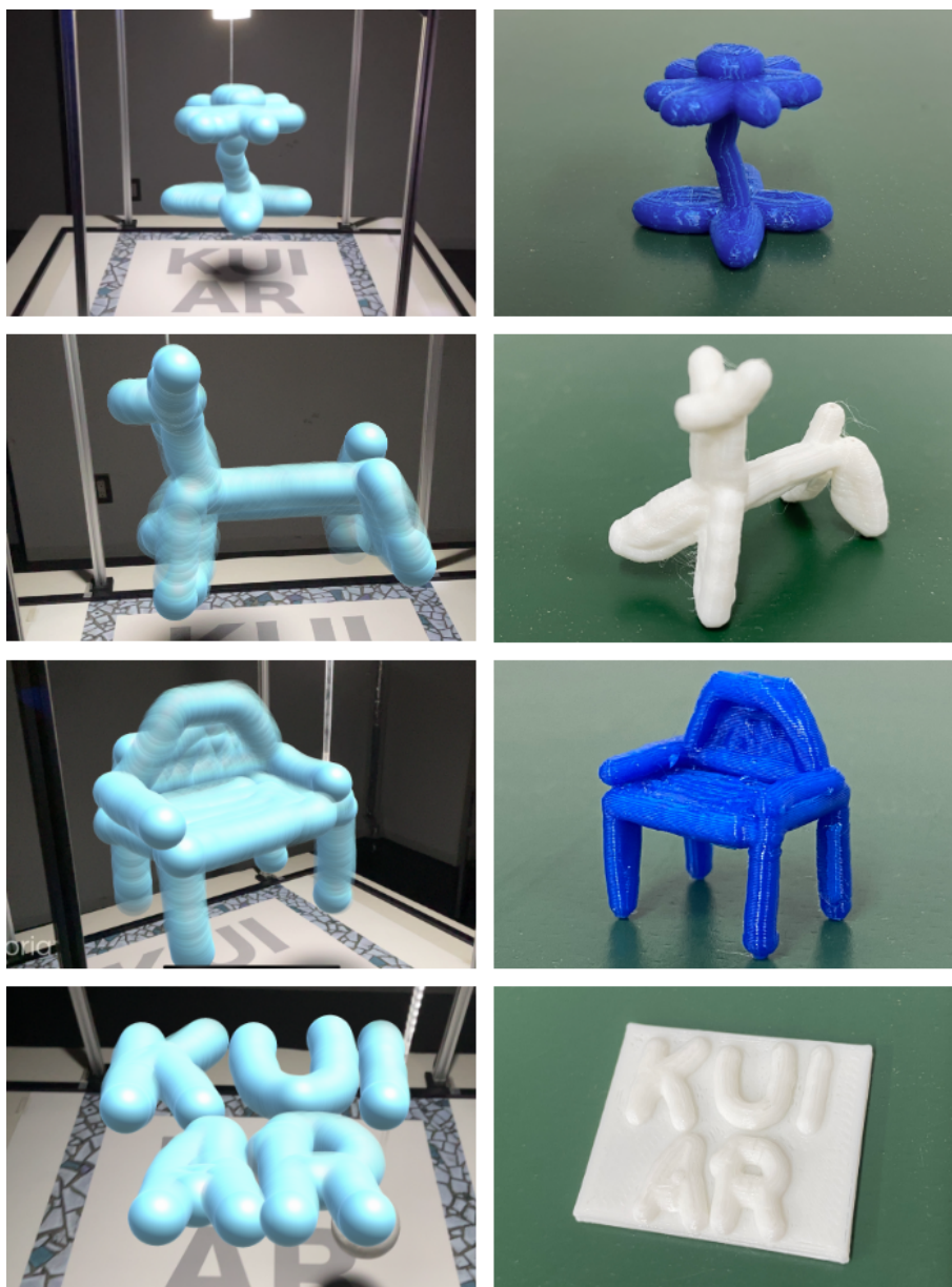
図 6.15: 作成した 3D モデルと 3D プリントの結果
