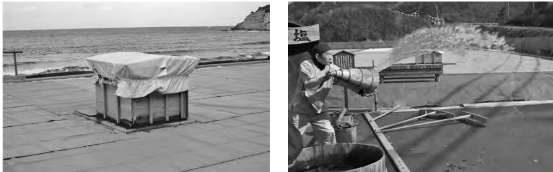
図4 揚浜式塩田の沼井（左）と撒潮の様子（右）（石川県輪島市；2013年11月撮影）
