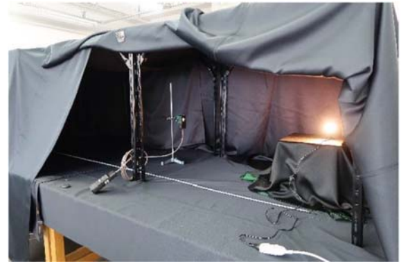
図6 星の明るさを測って距離を決める方法の模擬実験の様子
