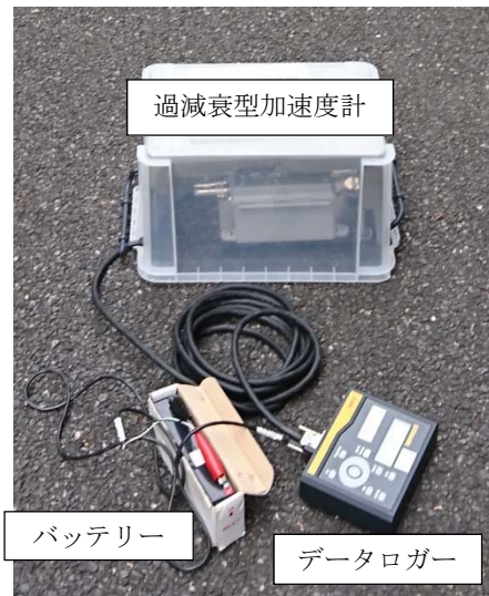
写真 1 常時微動計測システム
