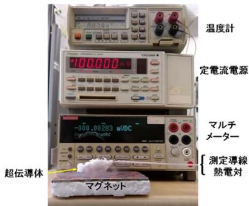
図 16 電気抵抗を測定しながら浮上している超伝導体
