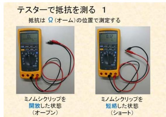
図 10 テスターのオープン(開放)、ショート(短絡)の実験
