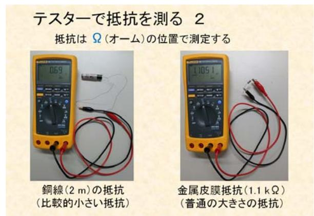
図 11 テスターによる抵抗測定実験
