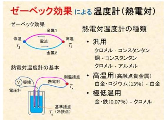
図 13 熱電対温度計の説明
