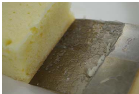
図19 チタン電極で焼き上げたパン
