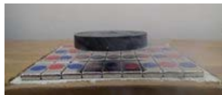
図11 超伝導体の永久磁石上での浮上
