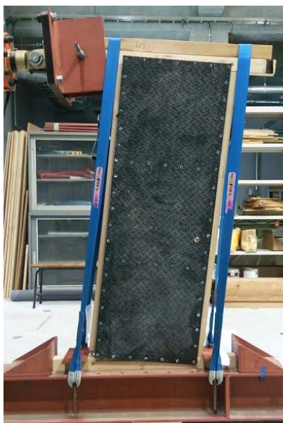
写真 1 大壁式プラパネル耐力壁の変形状況
