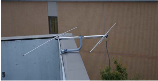
図 6 発信元の福井高専の東が指向方向になるように水平に設置したアンテナ
