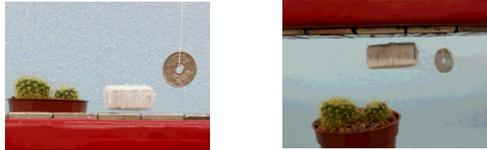
図 7 磁気浮上 (a) と磁気懸垂 (b)
